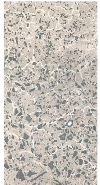
Desbaste superficial con disco metálico #200, utilizando Kick Start y riego de la superficie del piso. Este procedimiento es realizado continuamente posición transversal al desbaste #30, cepillando y limpiando la superficie con el liquido formado por Kick Start.
